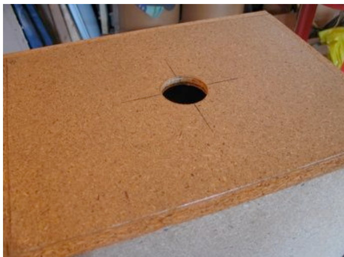
Photo 7. Que vous réalisiez l'aération 1 ou la 3, elle se fait au centre du panneau (E pour la 1, D pour la 3). Elle fait 6 cm de diamètre.
