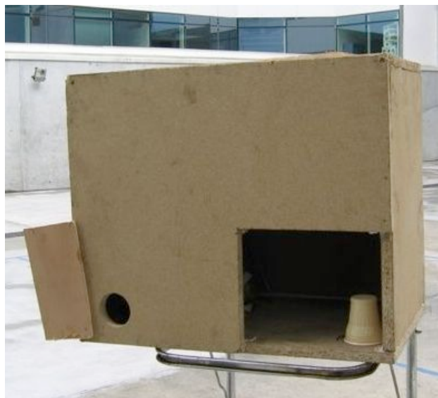
Photo 9 : mini-maison utilisée en position horizontale. Aérations 3 et 4.
