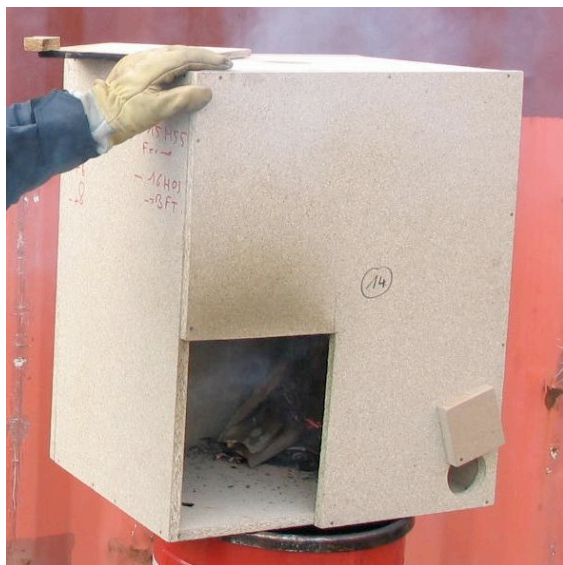
Photo 9 : mini-maison utilisée en position verticale. Aérations 1 et 2.
