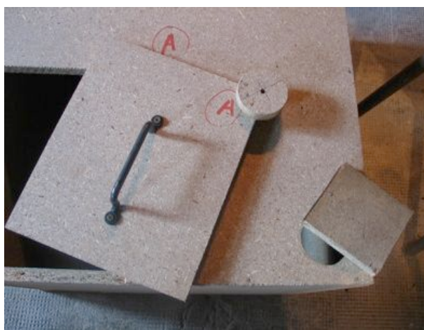
Photo 2 – La porte découpée, avec sa poignée et à droite la petite planche pivotante sur l'aération de façade.
