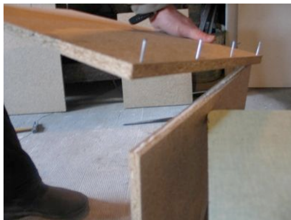
Photo 4 – Poser le côté du panneau C sur la tranche préencollée du panneau E, et clouez.
